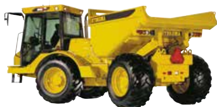
Hydrema 912 med sidetip, centralsmøring og affjedret foraksel
